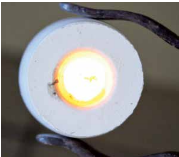
Figura 29 - Liga injetada pela centrifuga para dentro do revestimento.
