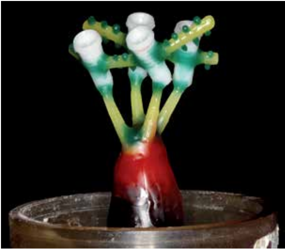
Figura 23 - Montagem do enceramento e confecção da boneca no anel de fundição.
