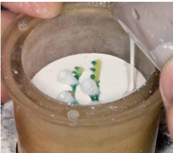
Figura 25 - Revestimento vertido no anel de fundição e recobrimento do enceramento.
