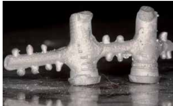
Figura 33 - Rebarbas existentes logo após a fundição da barra metálica (área de conexão dos sprues).
