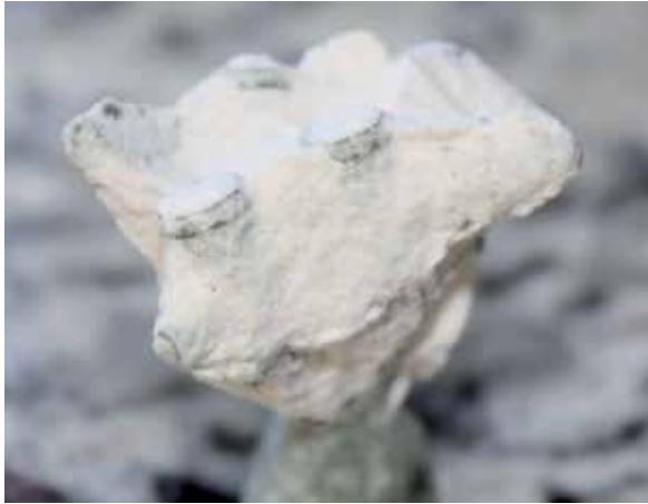
Figura 30 - Metal recém desincluído do revestimento.
