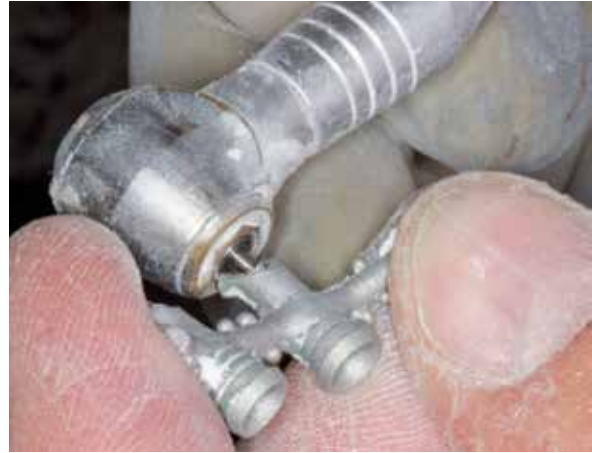
Figura 31 - Parte da barra fundida sendo limpa com broca.
