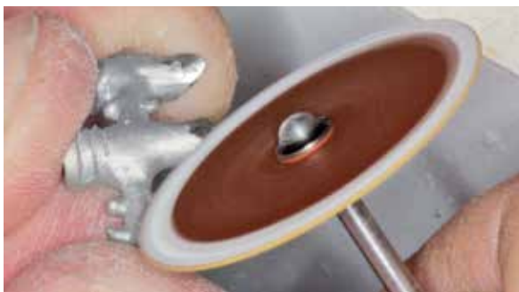
Figura 34 - Usinagem da barra metálica e remoção de excessos metálicos.
