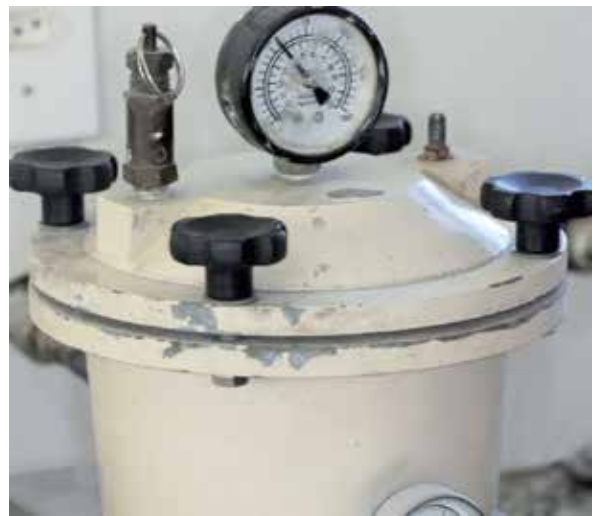
Figura 26 - Anel de fundição e revestimento posicionados no pressurizador para minimização da formação de bolhas.
