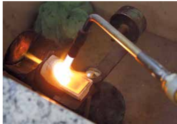
Figura 28 - Fundição da liga em cadinho para injeção no interior do revestimento.
