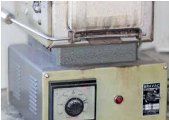
Figura 27 - Revestimento levado ao forno para a volatilização da cera.
